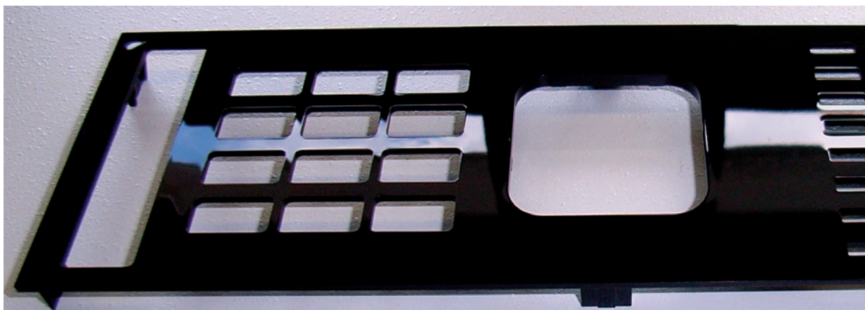
Bild 3 zeigt eine Blende, bei der aufgrund der Durchbrüche sowie der notwendigen Mehrfachanbindung eine Vielzahl von Bindenähten entsteht, die bei der Hochglanzpolitur als Fließmarkierungen in Form von Kerben zu erkennen sind (siehe Bildausschnitt in Abb. 4).
