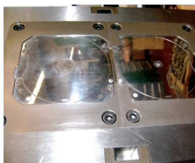
Beteiligte Jugendliche an der Spritzgießmaschine (o.), das selbst entwickelte Werkzeug in der Maschine (i.).
