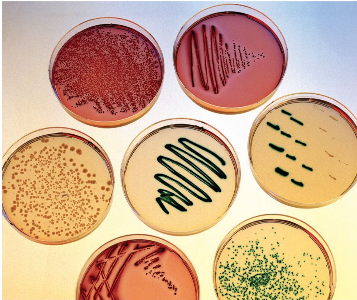
Bakterienkulturen auf einem Nährboden in Petrischalen geimpft: Nach einigen Stunden im Wärmeschrank zeigen sie klare Strukturen und lassen sich zählen. Dann wird klar, welche antibakteriellen Beschichtungen wirklich Wirkung zeigen. (Foto:Forschungszentrum Jülich)
