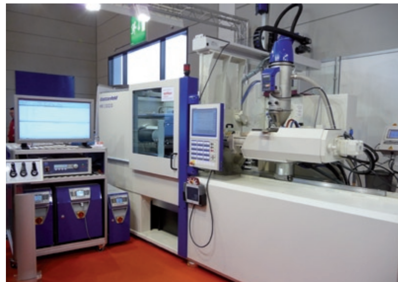
Komplettlösung Wittmann Battenfeld-Spritzgießmaschine HM 110/210 mit Unilog B6 Steuerung, Wittmann-Entnahmegesamtanlage sowie Trocknung, Förderung und Dosierung sowie Kühlung und Temperierung
