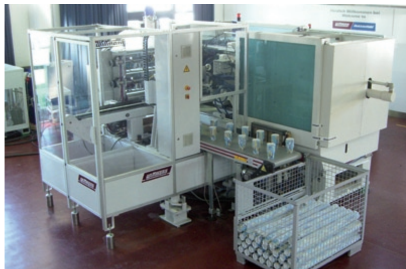
Komplettlösung der Wittmann Gruppe: In Mold Labeling Anlage bestehend aus Schnellläufer-SGM TM Xpress und Hochleistungswerkzeug verbunden mit Einlege- und Entformungsautomatisierung sowie Kühlgeräten
